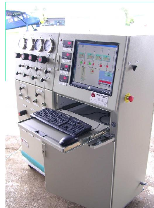
Valise de test pressu – *Pressure test tool*
