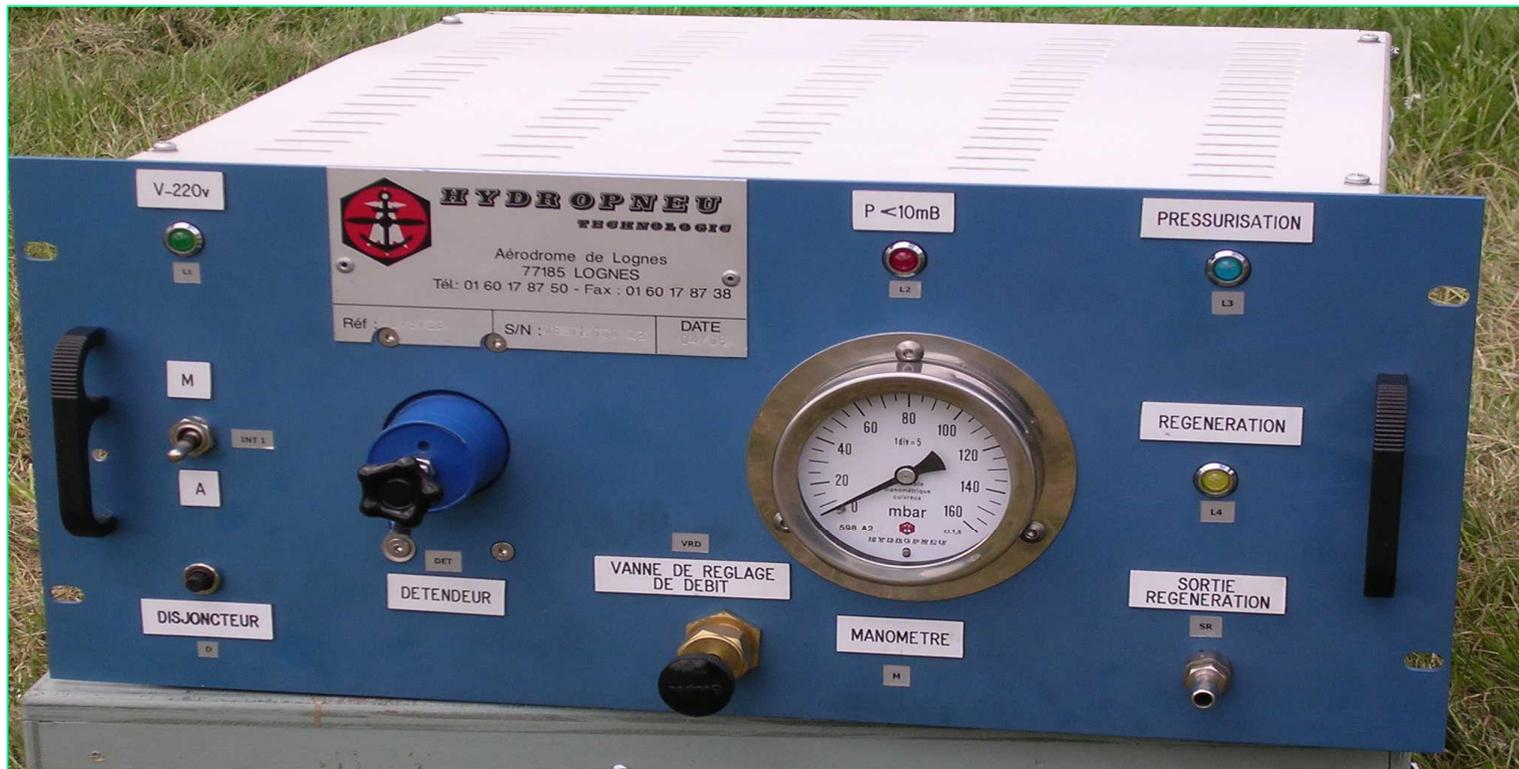
Pressurisateur – assecheur d'air utilisable dans les guides d'ondes des radars
