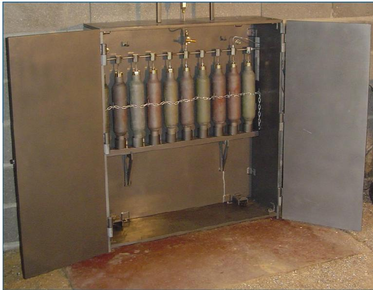
station de timbrage pour la requalification des réservoirs sous pression jusqu'à 1500 bar
