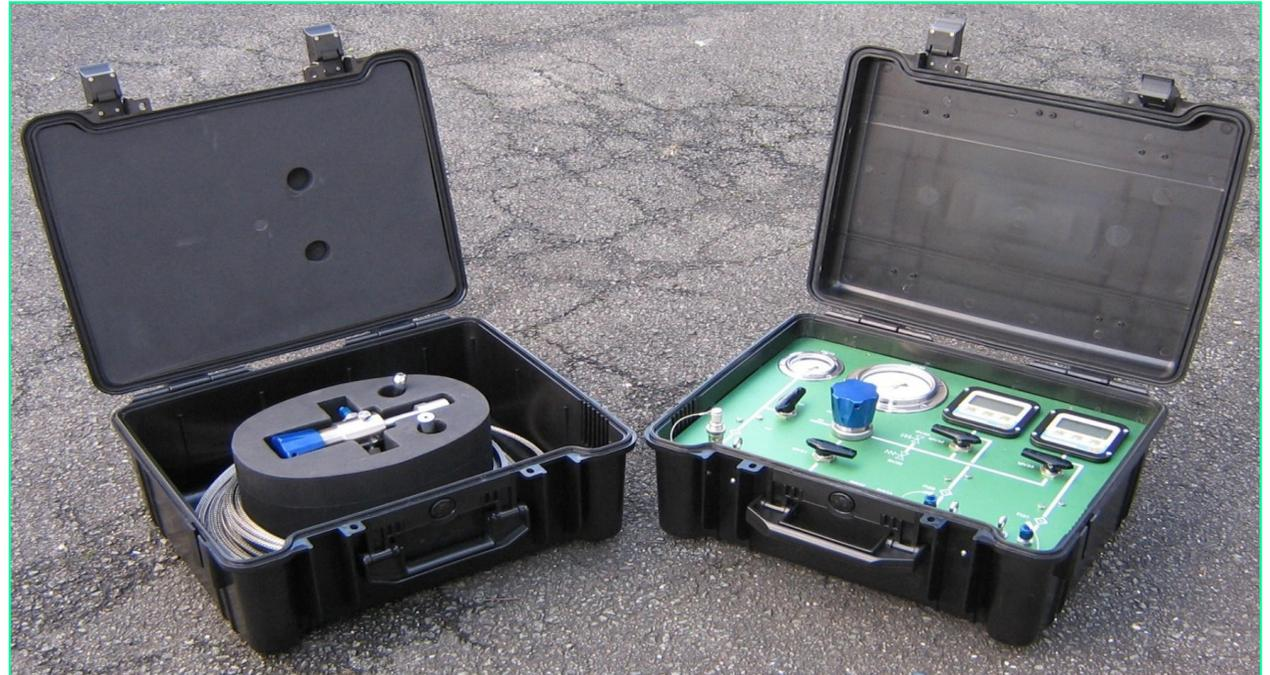
*Valise de test en pression – Pressurization test tool*
