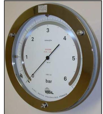
L'utilisation d'un cadran avec miroir supprime l'erreur de parallaxe et permet ainsi une lecture précise.
