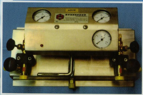
Centrale de détente à inversion automatique 350 bar amont, jusqu'à 100 bar aval, débit jusqu'à 500 Nm 3 /h.
